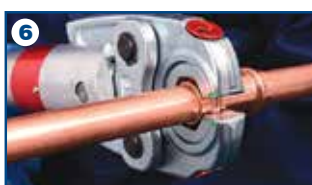
Allineamento delle ganasce al raccordo
