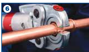
Allineamento delle ganasce al raccordo
