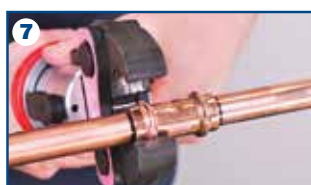
Completare il ciclo di pressatura. Pressare una sola volta
